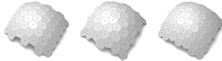
Abbildung 25: Auswirkung der „pattern points“ auf die Geometrie der Facetten (Stavric et al. 2014)
