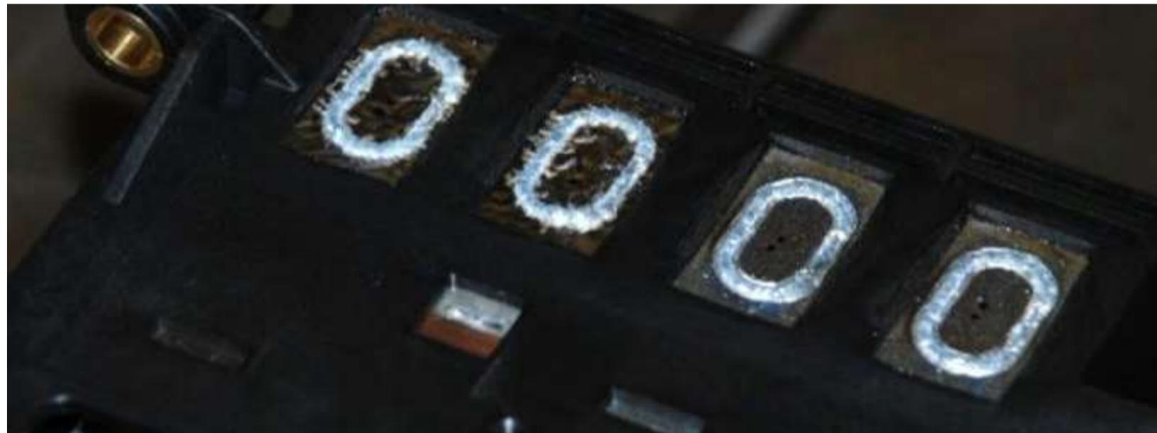
Laserschweißen von Batteriekontakten für die Entwicklung in der e-Mobility
