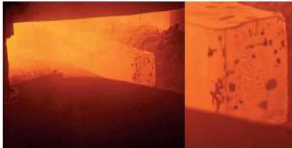
Abbildung 3: Heiße Knöppel direkt aus dem Ofen mit Kennzeichnung an der Stirnseite
