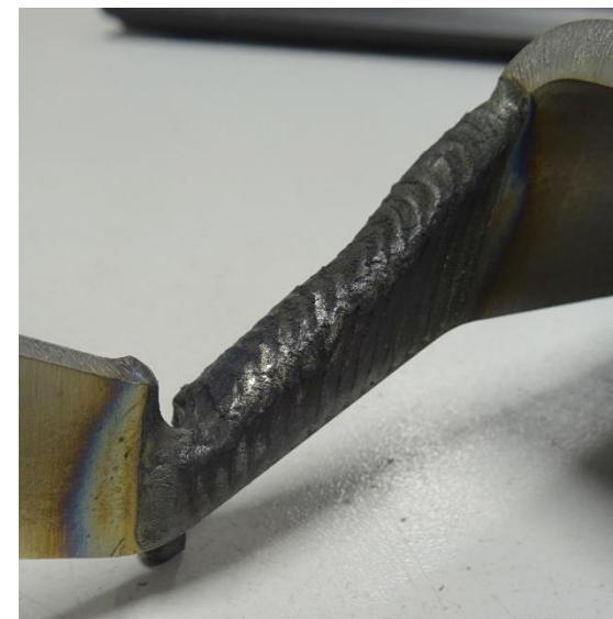
Versuch Nr. 1: komplettes Durchschmelzen des Bügels.
