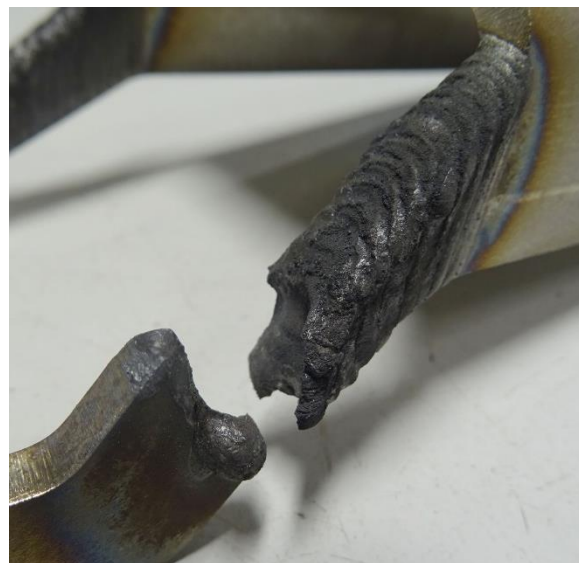
Versuch Nr. 1: komplettes Durchschmelzen des Bügels.
