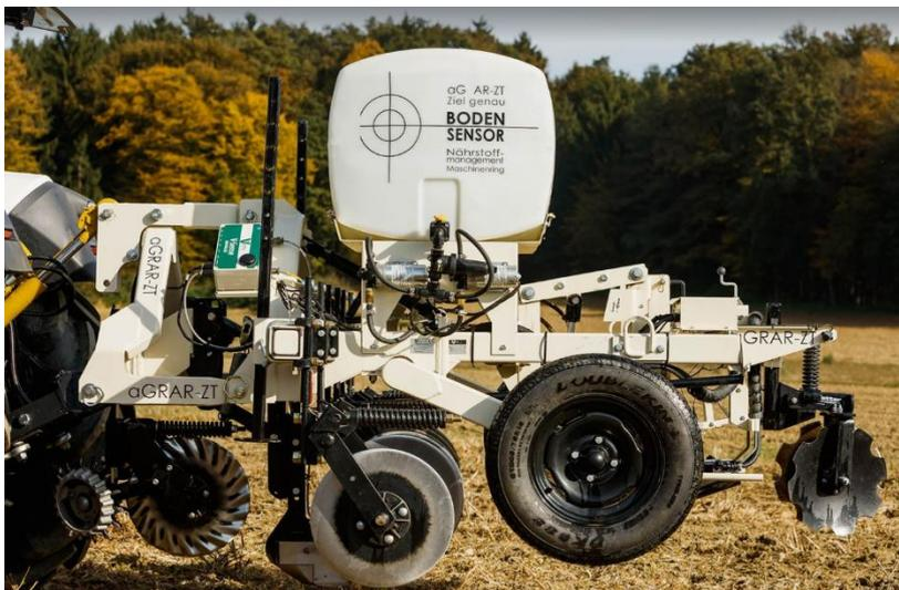
Abbildung 13 Veris-Bodensensor Befestigung
